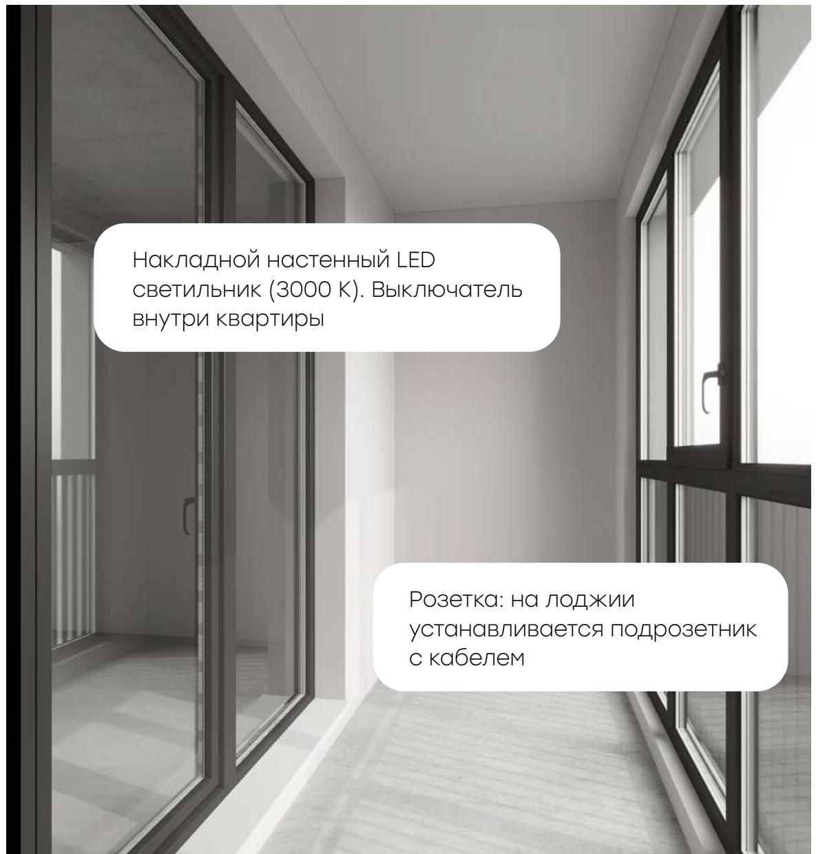
Накладной настенный LED светильник (3000 K). Выключатель внутри квартиры
